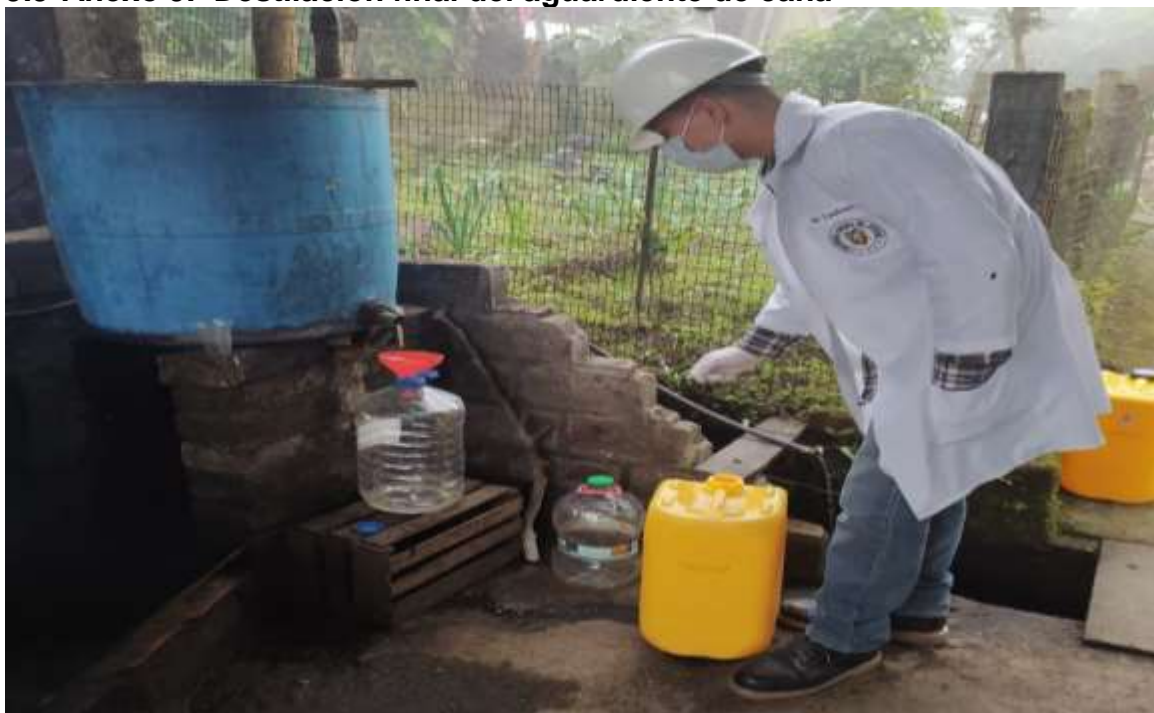
Figura 14. Destilación final del aguardiente de caña Zambrano, 2020
