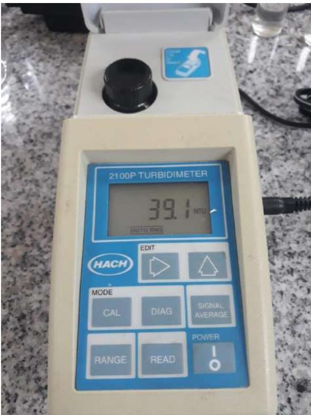
Figura 14. Medición de turbidez
