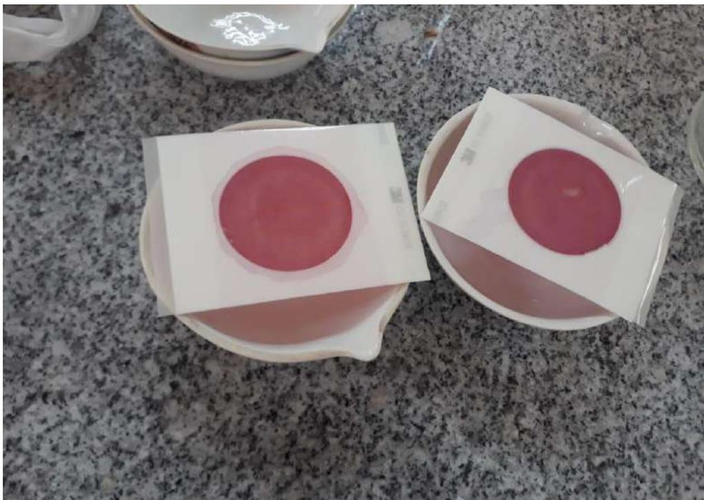
Figura 15. Medición de coliformes fecales
