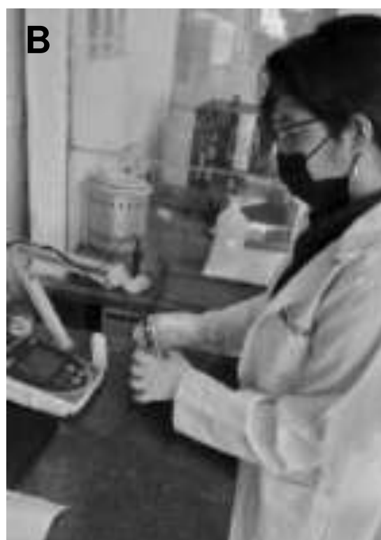
Figura 55. Determinación de pH por el método potenciométrico Vera, 2022
