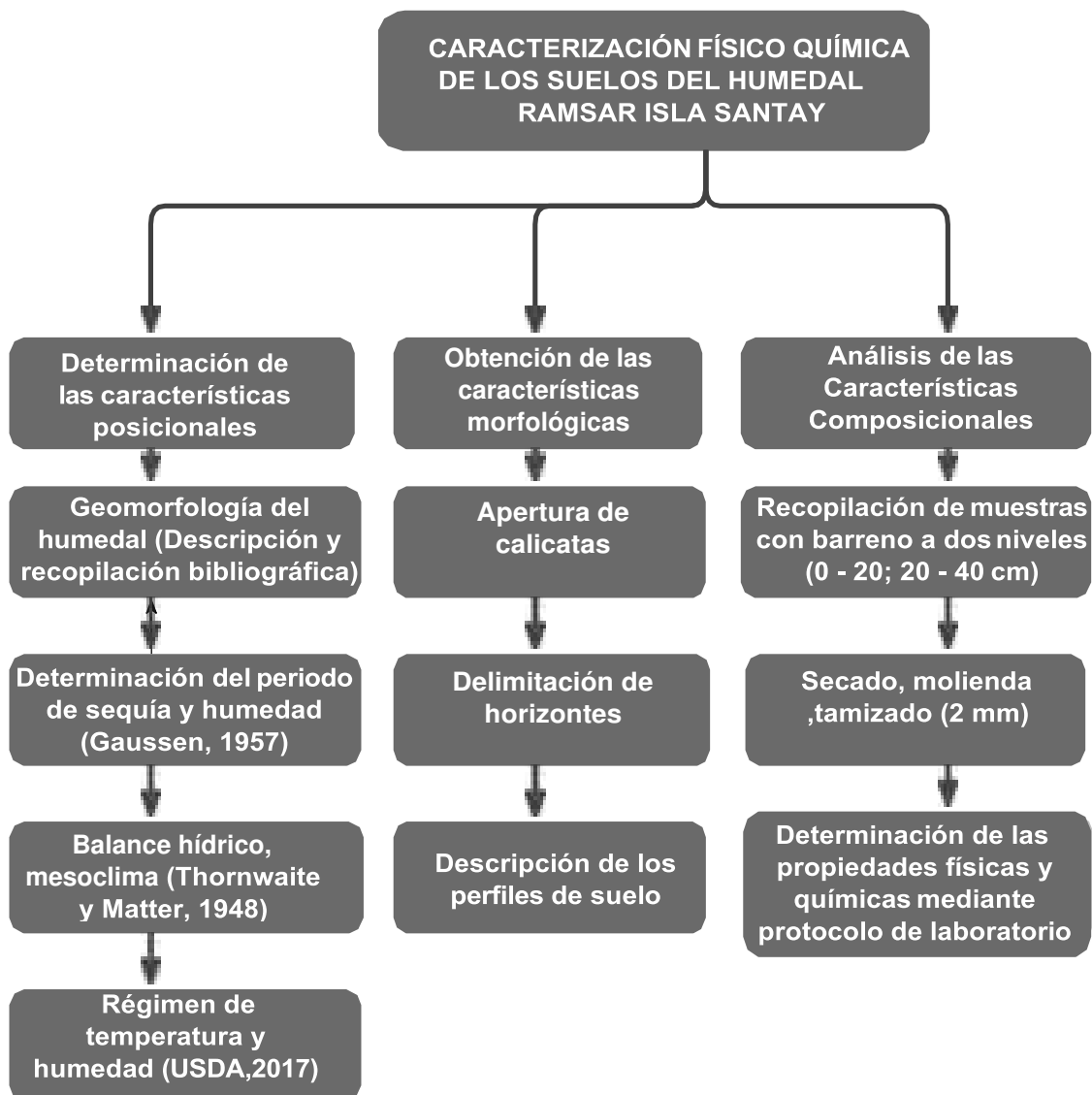
Figura 1. Diagrama de flujo para la determinación de las características posicionales, morfológicas y composicionales de la Isla Santay Vera, 2022
