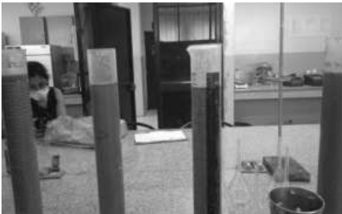
Figura 54. Determinación de la clase textural mediante el densímetro Bouyoucos Vera, 2022
