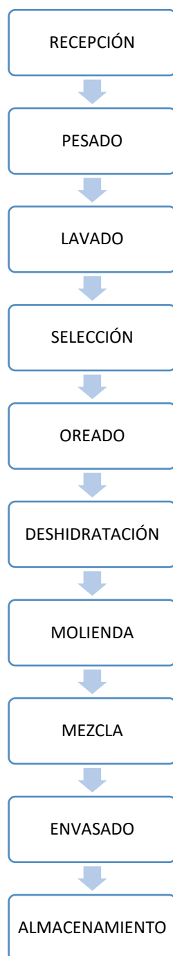
Figura 1. Diagrama de flujo para elaboración de infusión filtrante a base de cáscaras de piña y toronja Velasco, 2023
