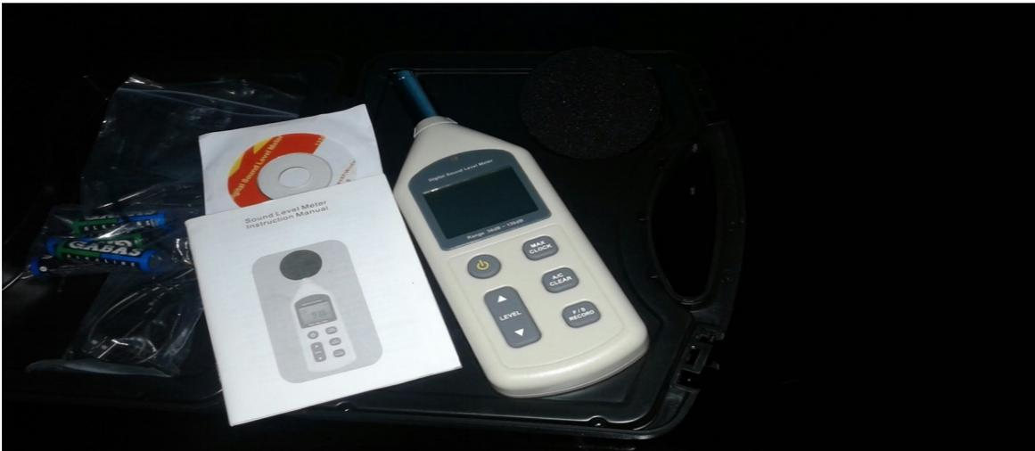
Figura 14. Sonómetro IEC651 TYP2 y ANSI S1. 4 TYPE2
