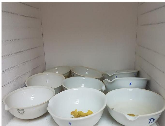
Figura 29. Muestras colocadas a calcinación
