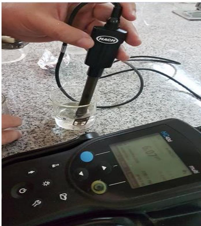
Figura 32. Determinación de pH a las muestras de aguacate calcinadas
