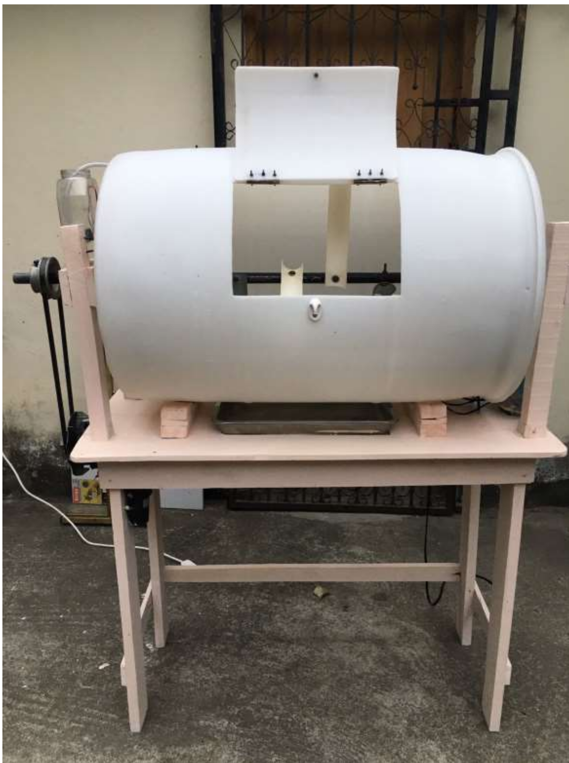
Figura 35. Máquina de compostaje de tipo horizontal automatizada Fernández y Vásconez, 2021
