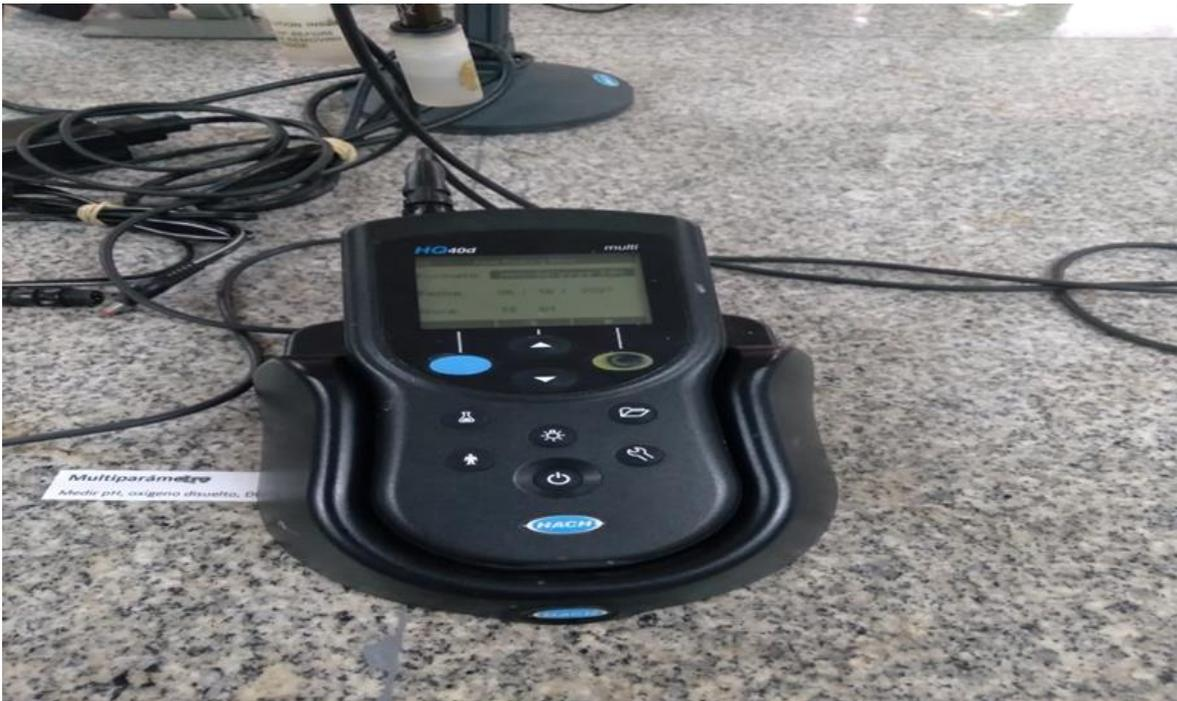
Figura 11. Toma de potencial de hidrógeno en los tratamientos de aguas residuales. Tamayo, 2021
