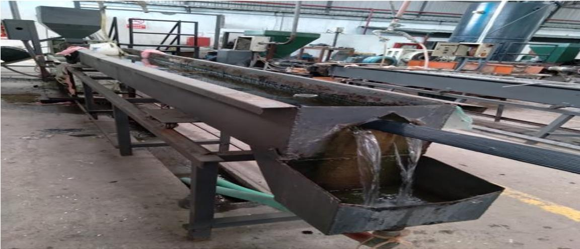
Figura 5. Salida del agua de enfriamiento, conducida a la piscina de almacenamiento de aguas residuales.
