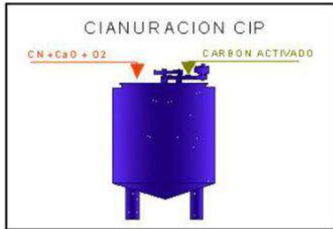
Figura 3. Tanque para adsorción por carbón
