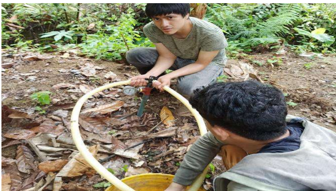
Figura 25. Se realizo el aforo volumétrico dentro del productor Martita 1 Sagñay, 2022
