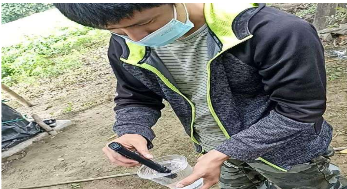
Figura 23. Análisis in situ con el Tester hanna (HI 98129) de pH/TDS/CE Sagñay, 2022
