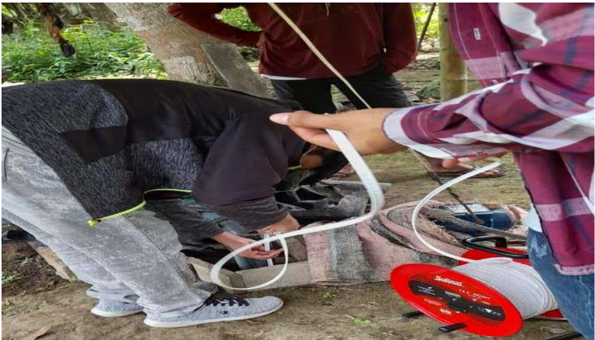
Figura 21. Nivel estático del productor Segundo Gómez con la Solinst 107 sonda TLC Sagñay, 2022
