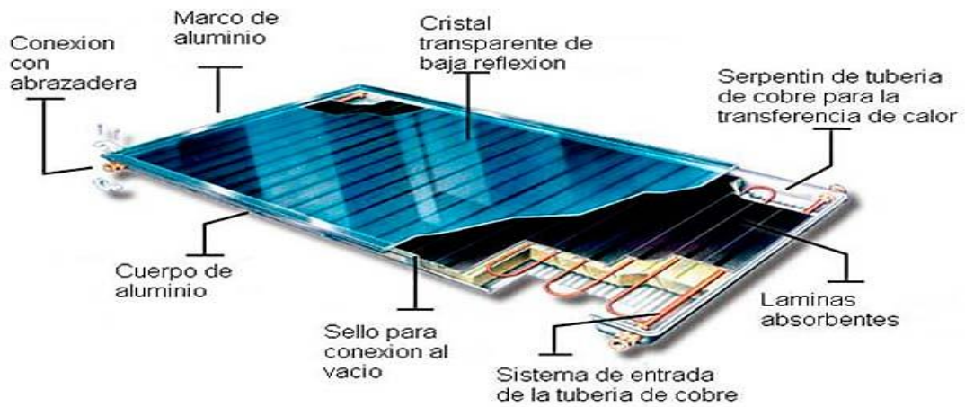
Figura 2. Componentes de un calentador solar plano de cobre Lozano, 2019
