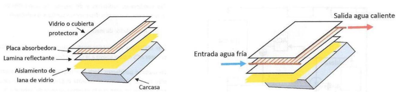
Figura n°7. Funcionamiento de un Colector de Placa Plana.
