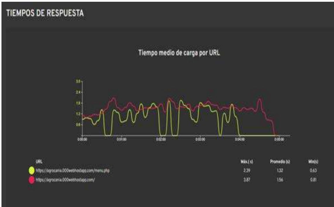
Figura 25. Caso de prueba 5: Prueba de rendimiento, tiempo de respuesta. Ramírez, 2022
