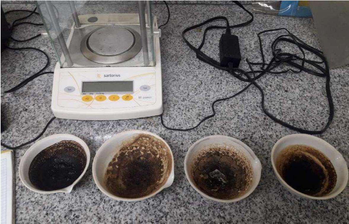
Figura 21. Determinación de sólidos suspendidos totales
