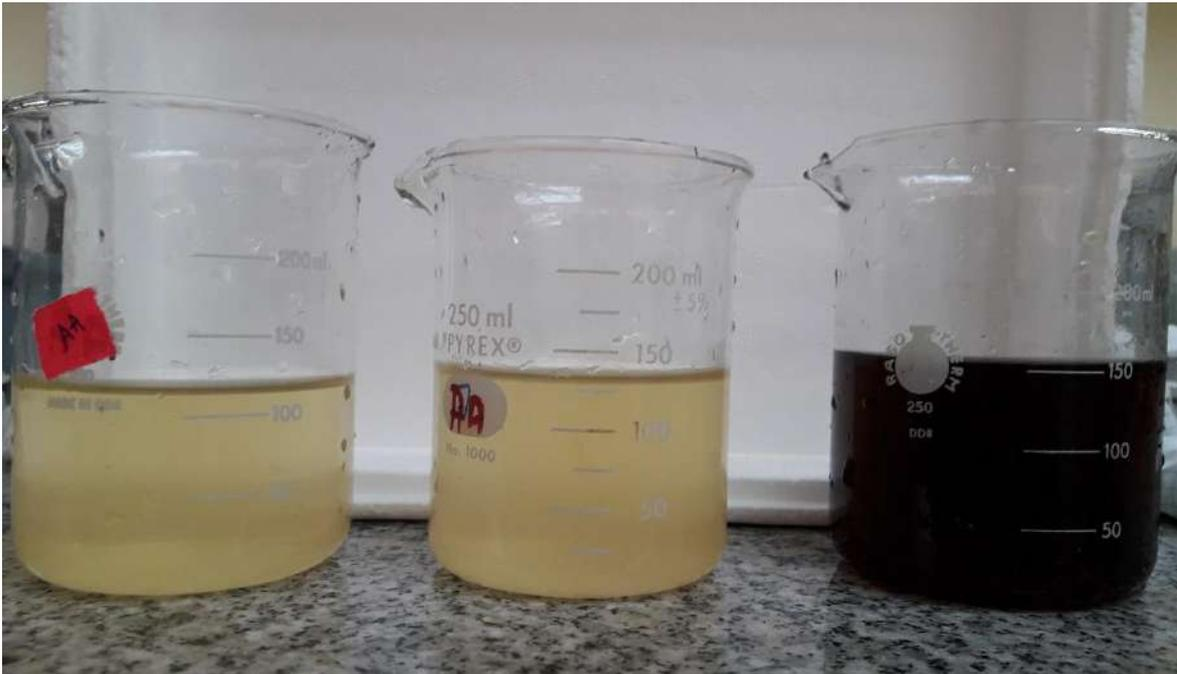
Figura 25. Muestra del lixiviado inicial y muestra tratada con cal
