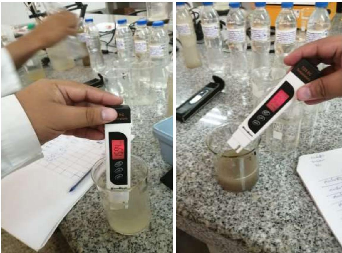
Figura 25. Determinación de los sólidos totales disueltos
