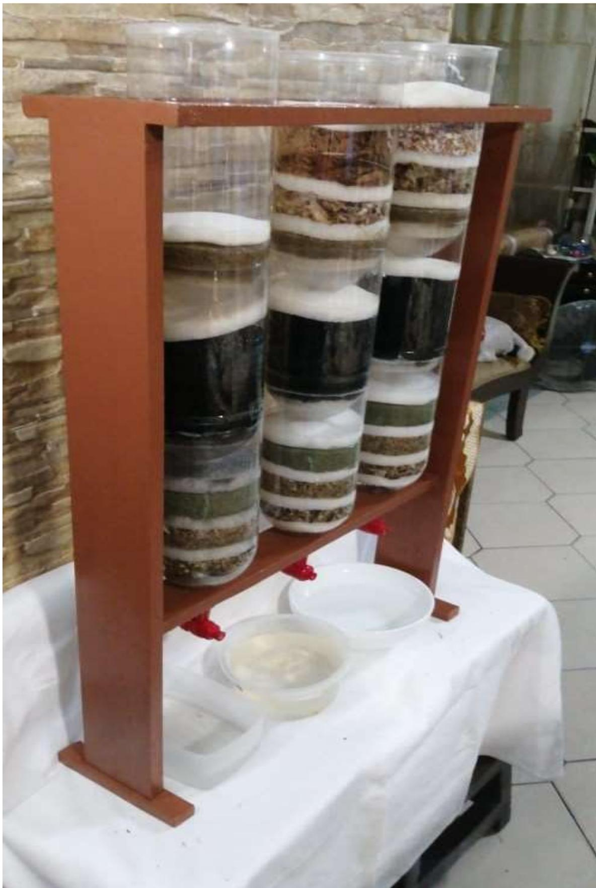
Figura 19. Diseño de los tres filtros
