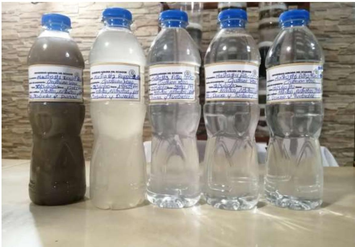
Figura 20. Muestras de agua antes y después del uso de los filtros
