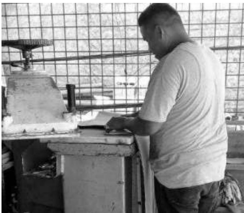
Figura 4. Troquelador encargado de hacer los cortes de las sandalias.
