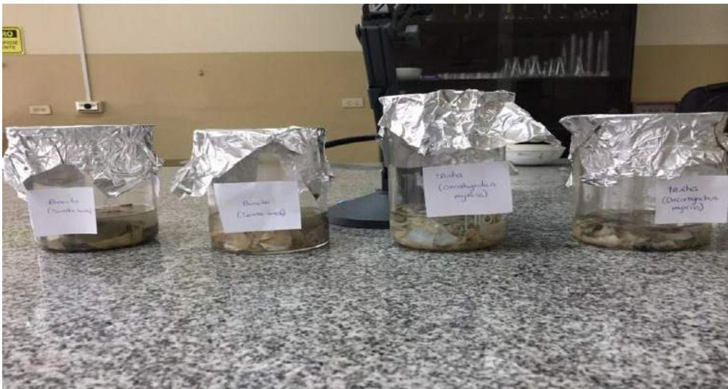
Figura 26. Desengrasado con una solución de D- limoneno al 1 % durante 24 horas
