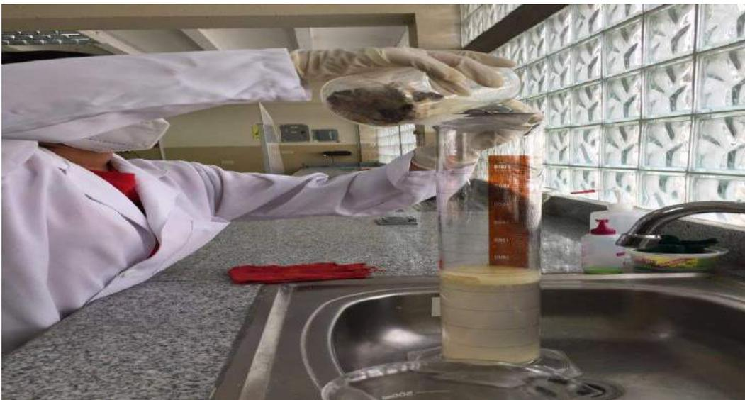
Figura 24. Filtración y limpieza de pieles con agua destilada extrayendo NaClO
