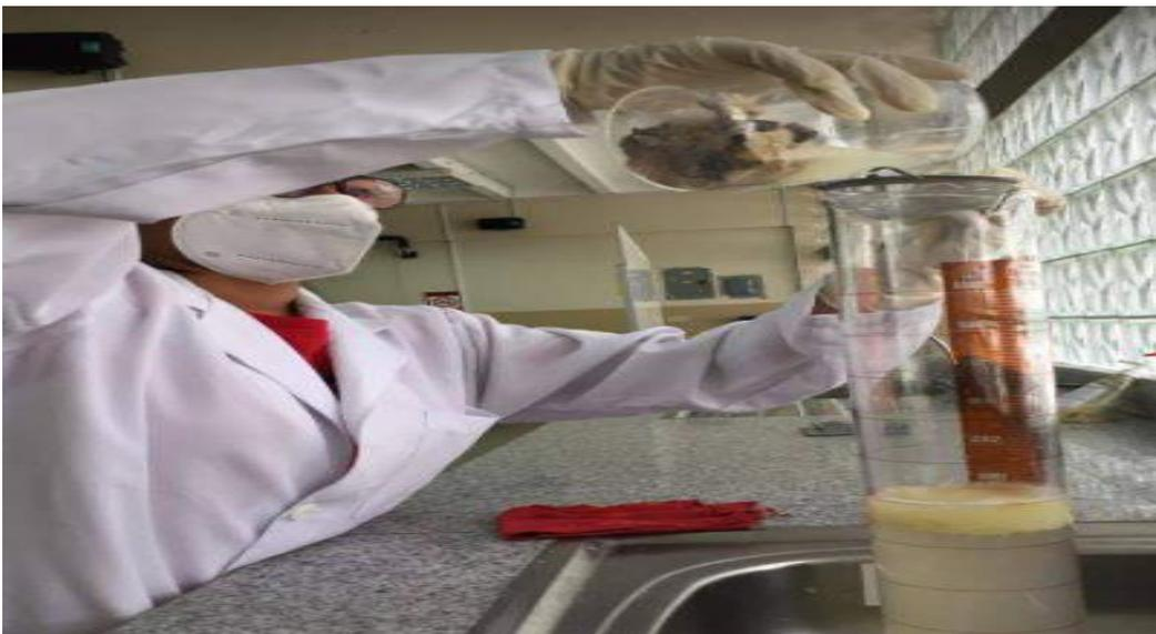
Figura 28. Filtración y limpieza de pieles con agua destilada durante 10 minutos extrayendo  $\text{H}_3\text{PO}_4$
