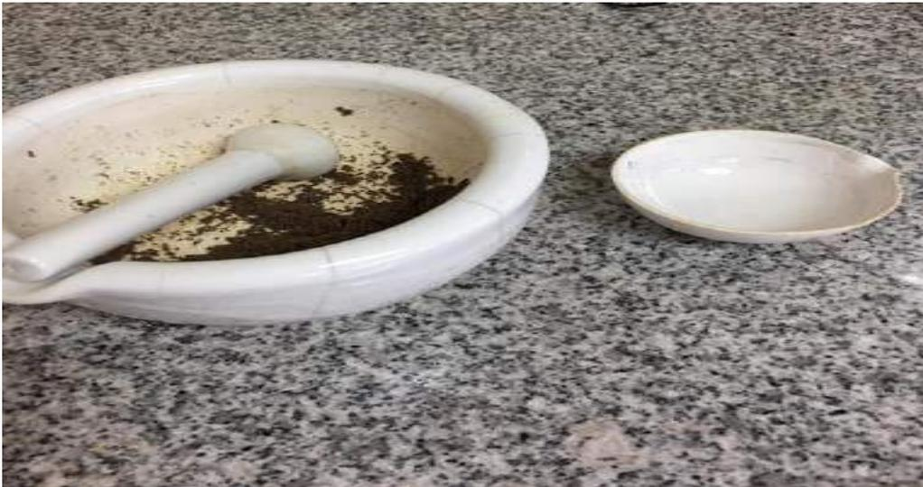
Figura 33. En el triturado en ambos colágenos se logró alcanzar pulverizarlo para obtener una consistencia homogénea
