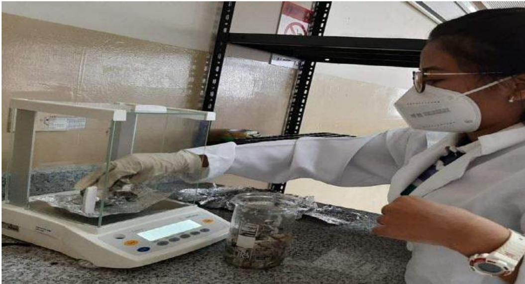
Figura 25. Peso de pieles después de la filtración y lavado bonito sierra 83.13 g y trucha 77.02 g
