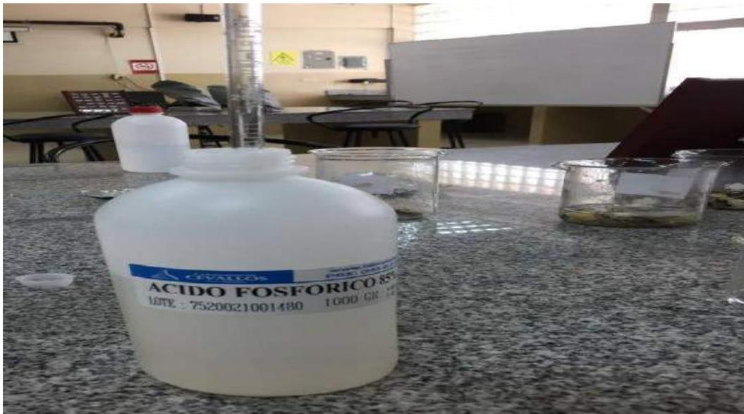
Figura 27. Tratamiento con  $\text{H}_3\text{PO}_4$  0.2 mol/ L en un tiempo de 42 horas
