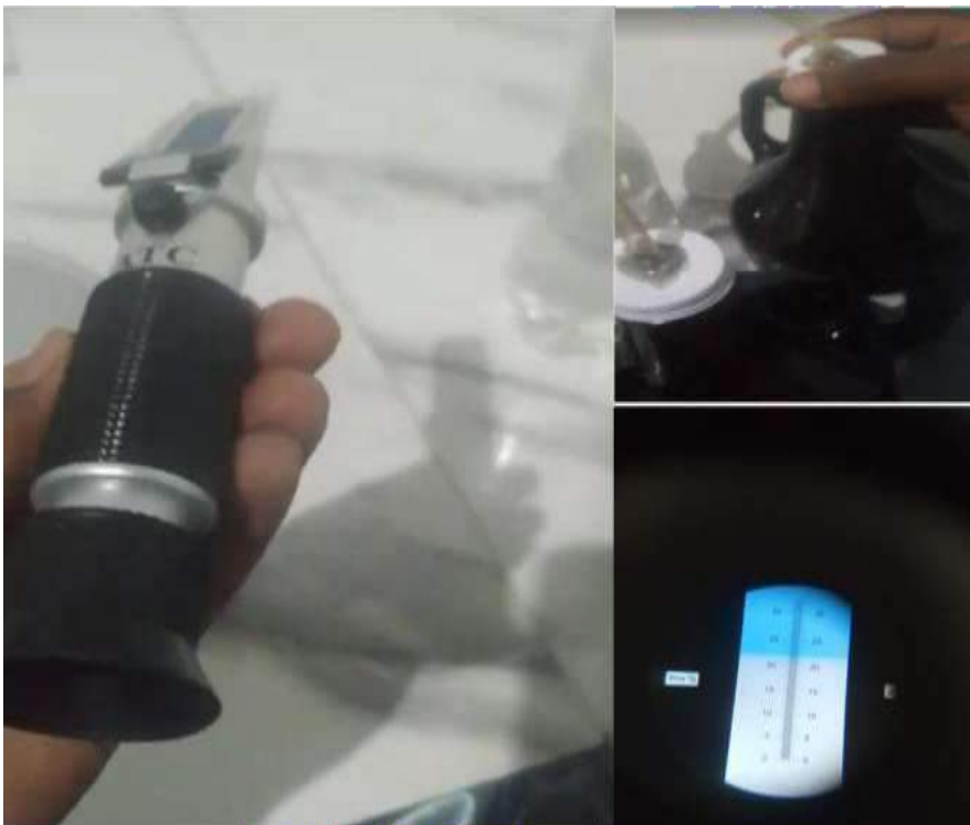
Figura 9. Determinación de los °Brix con el refractómetro Orovio, 2023
