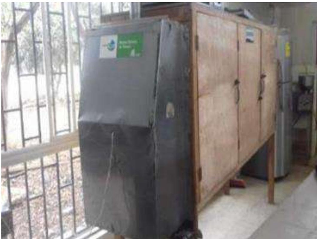
Figura 3. Deshidratación del Frejol Rojo en Deshidratador por Tunel
