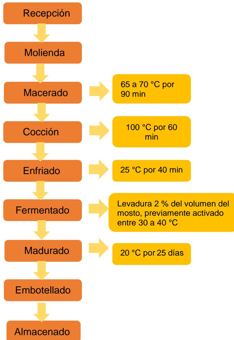
Figura 1. Diagrama de flujo de la sustitución parcial de la cebada por malteado de maíz y arroz en la elaboración de cerveza tipo Ale Narváez, 2021
