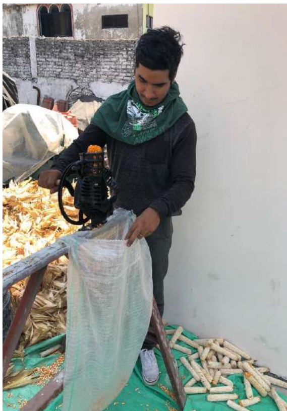
Figura 17. Desgranador manual, herramienta de apoyo para desgranar el maíz Montoya, 2022
