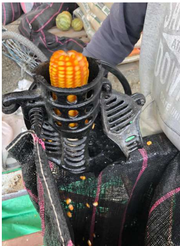
Figura 18. Desgranadora de maíz manual sin daño de granos y mazorcas Montoya, 2022
