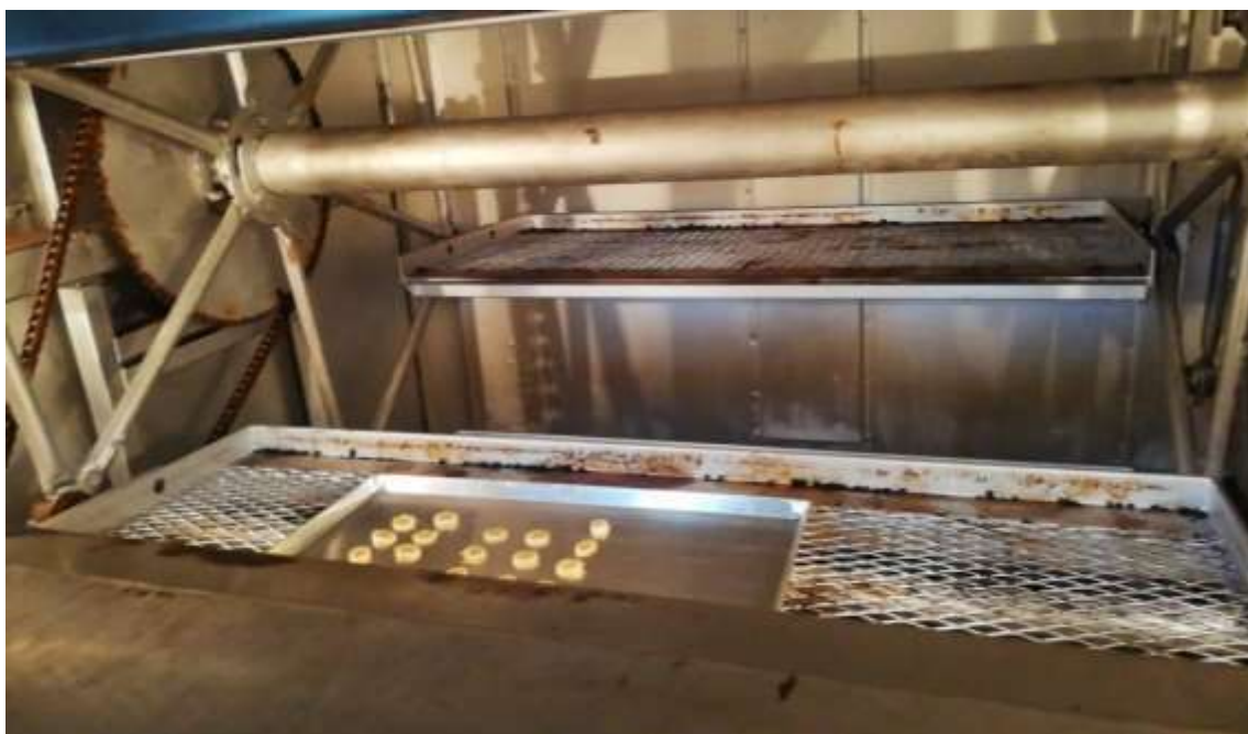
Figura 19. Deshidratación del banano en horno giratorio Mindiolaza, 2019
