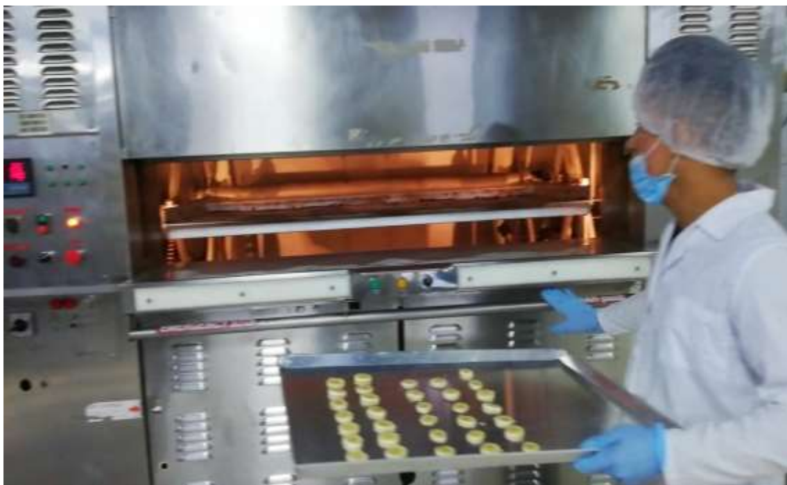
Figura 18. Equipo para la deshidratación del banano Mindiolaza, 2019
