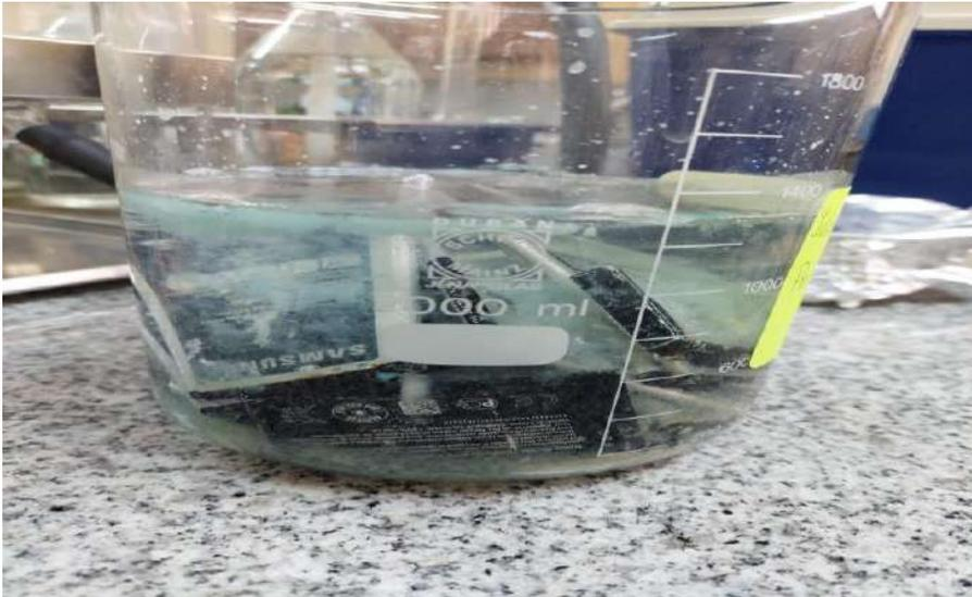
Figura 23. Descarga de las baterías de ion litio seleccionadas después de la revisión bibliográfica de sus respectivas fichas técnicas
