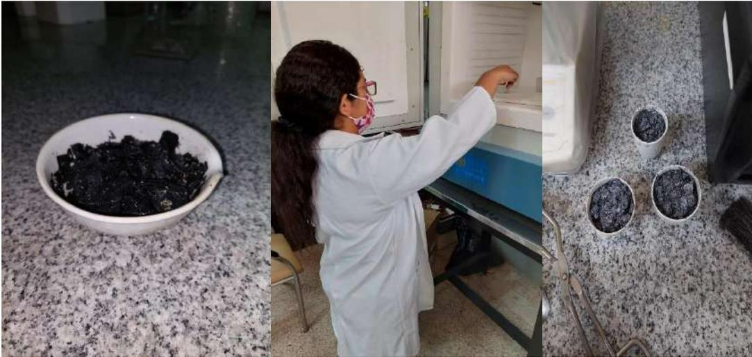
Figura 25. Cátodo de las LIBs antes (derecha) y después de la calcinación (izquierda) y tesista Yolanda Meza (centro) colocando la muestra del cátodo en la mufla a una temperatura de 700°C
