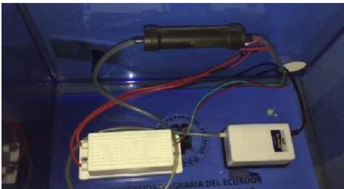
Figura 6. Equipo para emisión de ozono de 1ppm, 2ppm, 3 ppm Mendez, 2020
