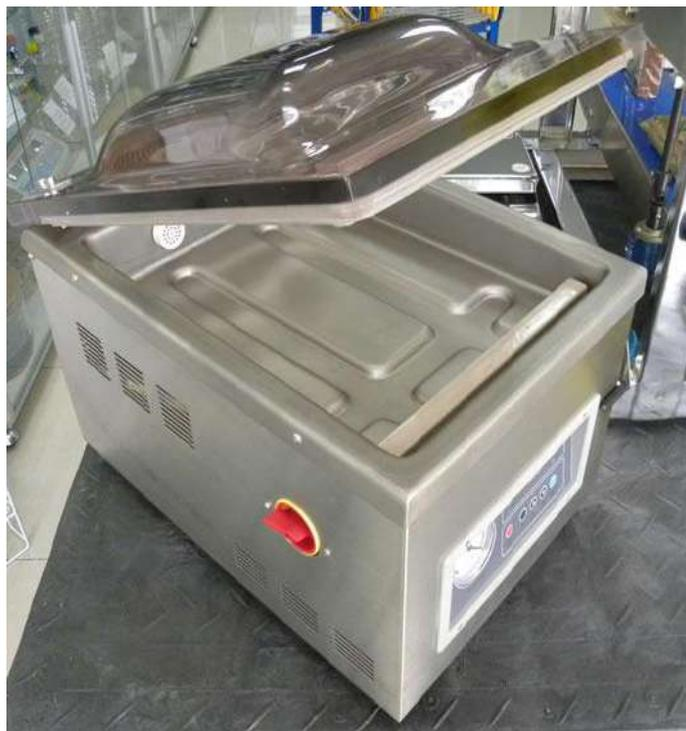
Figura 32. Máquina de empaque al vacío
