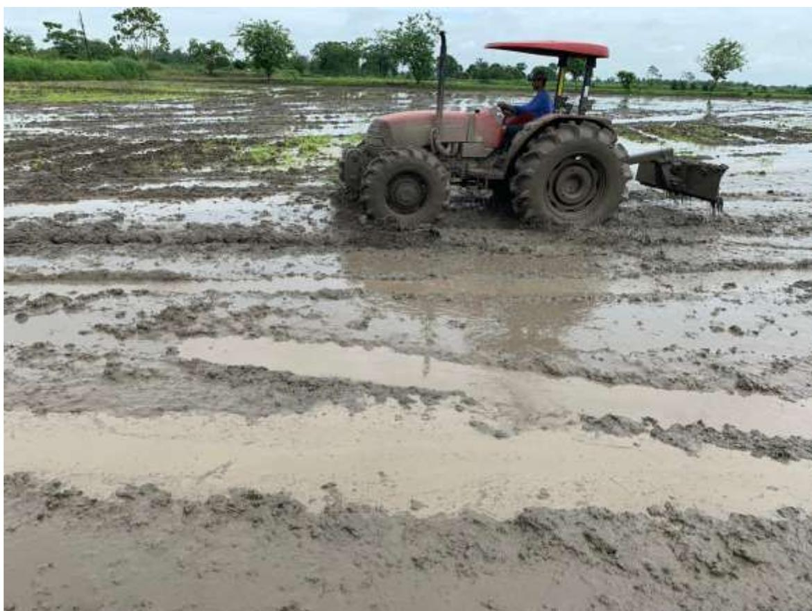
Figura 8. Preparación y fanguero del terreno
