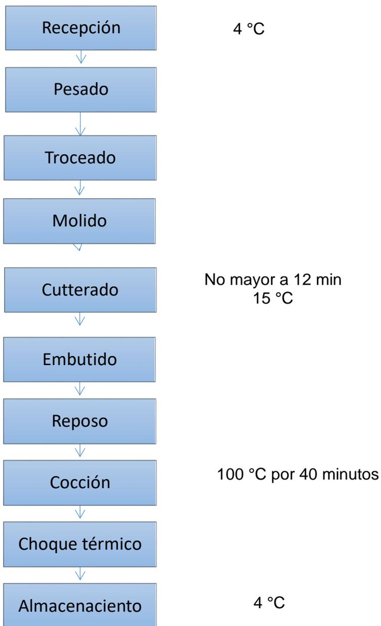
**Figura 1. Diagrama de flujo del proceso de elaboración de mortadela con codorniz y amaranto**
