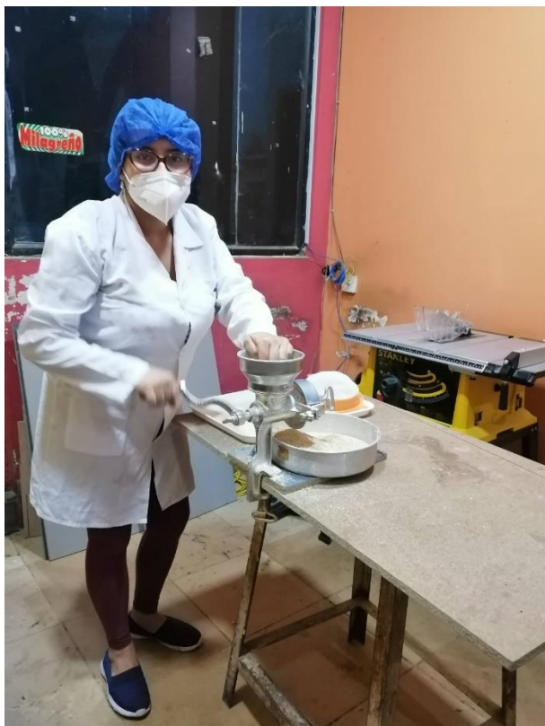
Figura 2. En el proceso de molienda de las materias primas Loor, 2021
