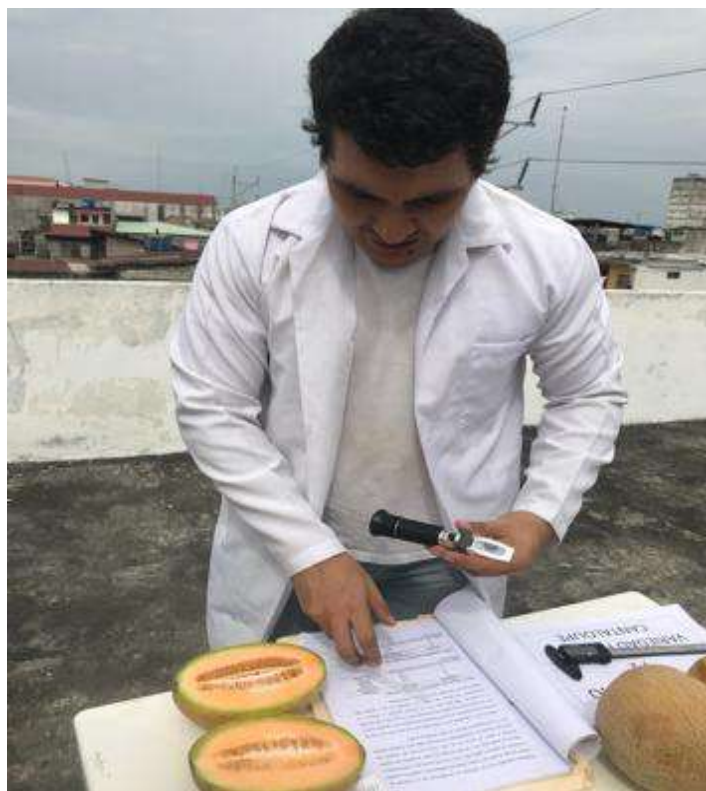
Figura 64. Medición de los grados Brix del melón mediante refractómetro Jiménez, 2020
