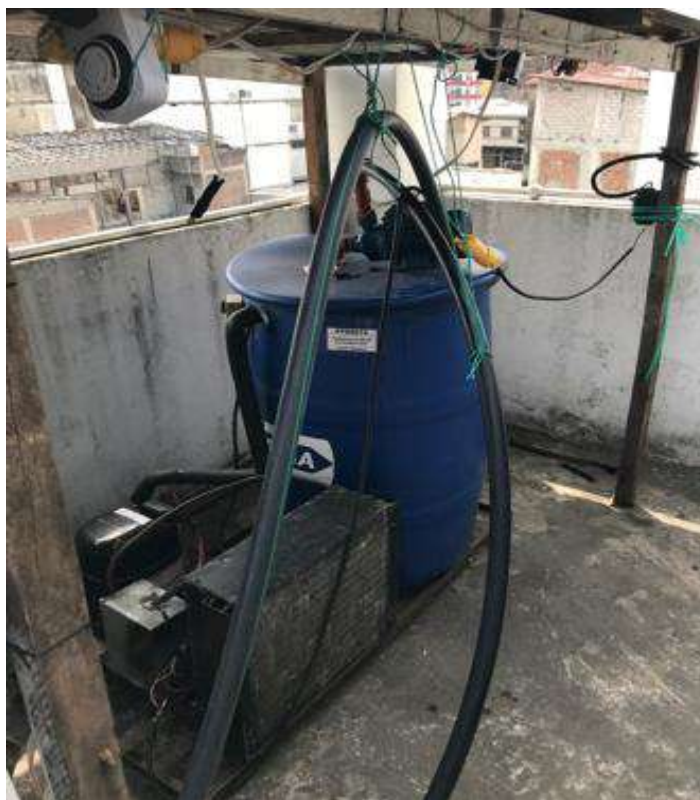
Figura 38. Mecanismo chiller artesanal utilizado Jiménez, 2020
