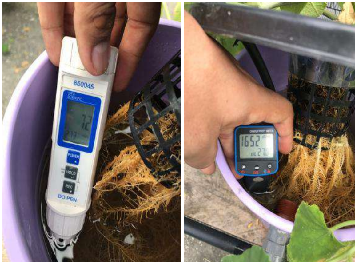
Figura 47 y 48. Medición de la variables en los baldes de oxígeno disuelto y conductividad eléctrica respectivamente Jiménez, 2020
