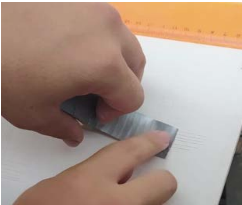
Figura 20. Aplicación de cinta adhesiva sobre la celda trazada y posterior retiro. Infante, 2022
