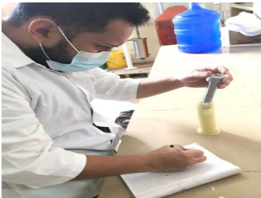
Figura 22. Medición de pH de una muestra de pintura (PCE- PH 20p/ cosméticos y pinturas) Infante, 2022
