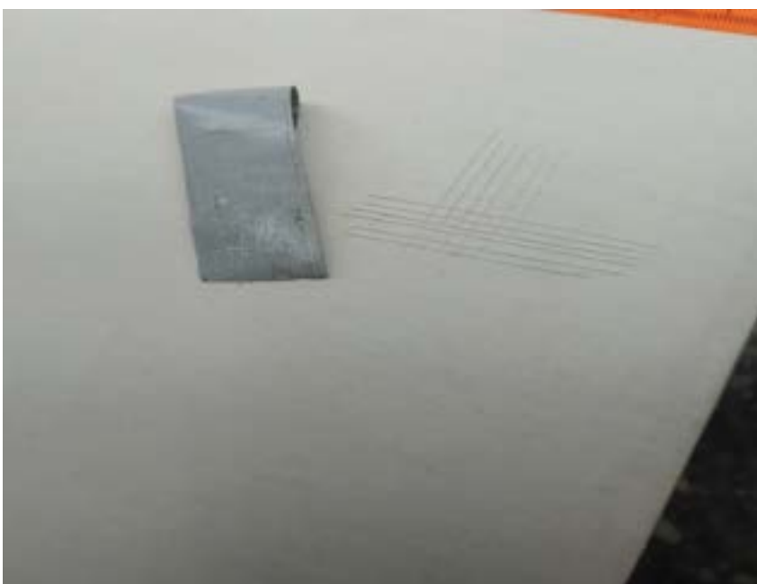
Figura 21. Observación y determinación del porcentaje de deterioro. Infante, 2022
