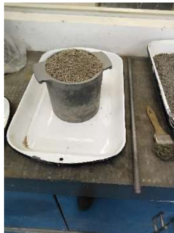
Figura 17. Determinación de la masa unitaria
