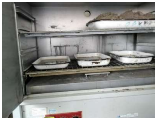
Figura 27. Secado de los materiales pétreos (arena, piedra y chasqui)
