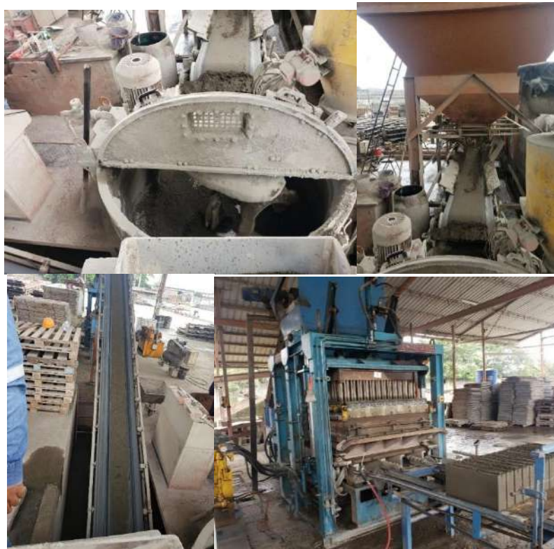
Figura 21. Producción de los bloques ecológicos
