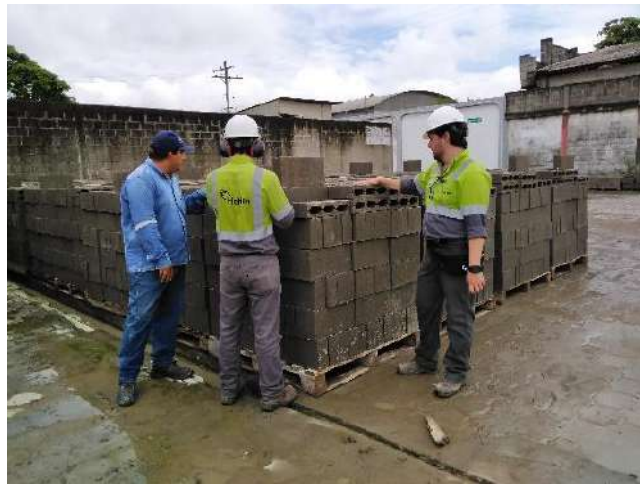
Figura 29. Verificación del curado de los bloques
