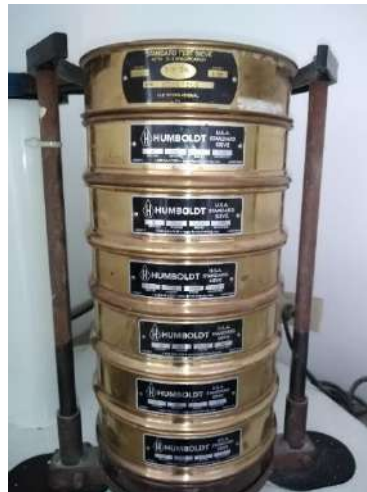
Figura 26. Tamizador de materiales pétreos
