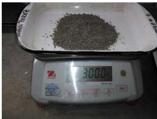
Figura 15. Granulometría de la piedra
