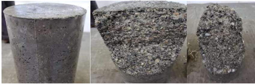
Figura 19. Ensayos de resistencia a la compresión de las probetas cuya dosificación contiene el 20% de PET reciclado.
