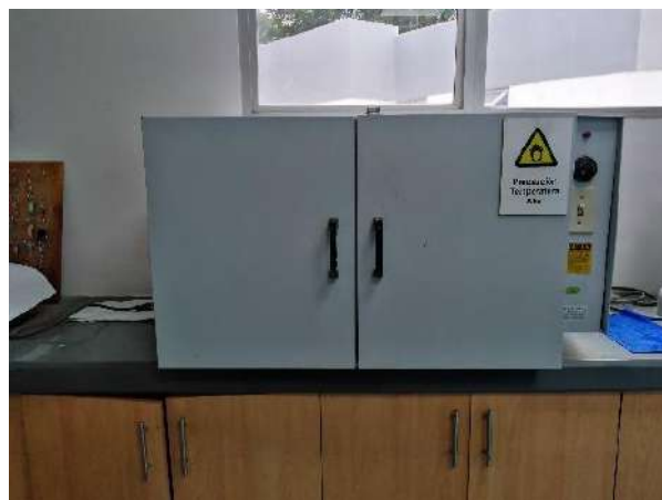
Figura 24. Secado de los materiales pétreos
