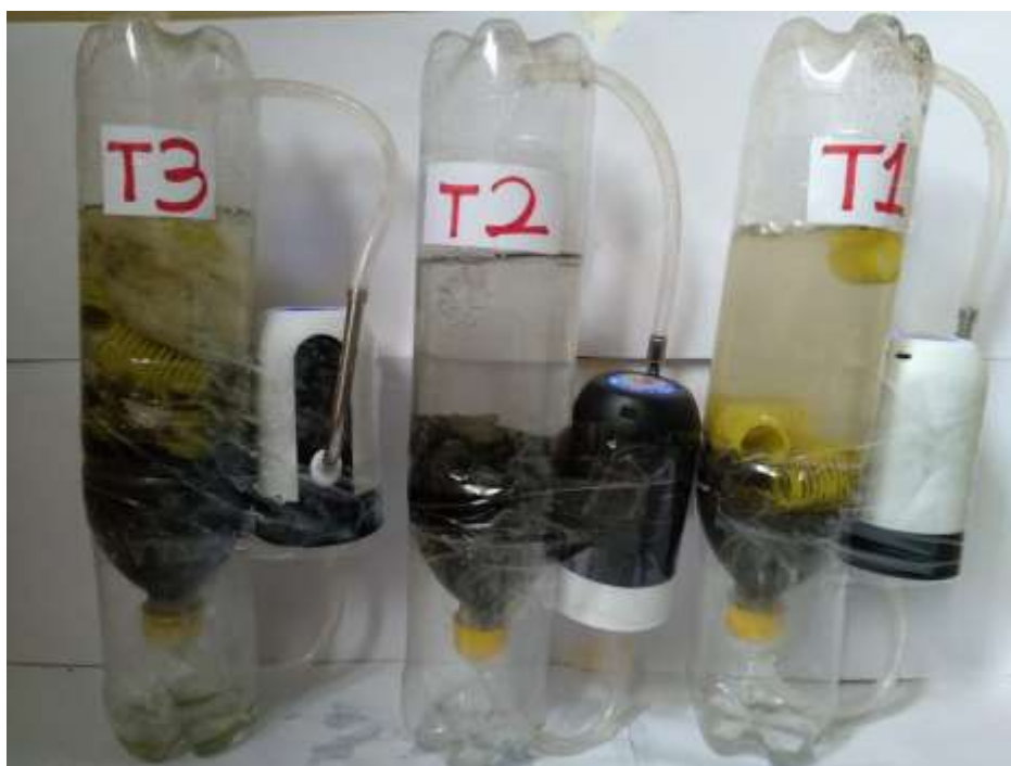
Figura 29. Biofiltro actuando para la remoción de contaminantes Haro, 2020
