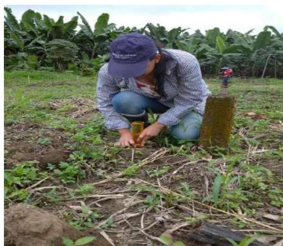
Figura 22. Instalación del pluviómetro y el cenirrometro
