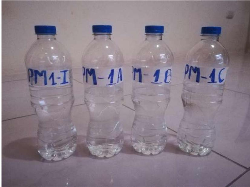
**Figura 12.** Muestra inicial pleamar recolectada a 1 milla (PM1 I) y muestras desalinizadas con replica de 3 (PM 1A, PM 1B, PM 1C).
