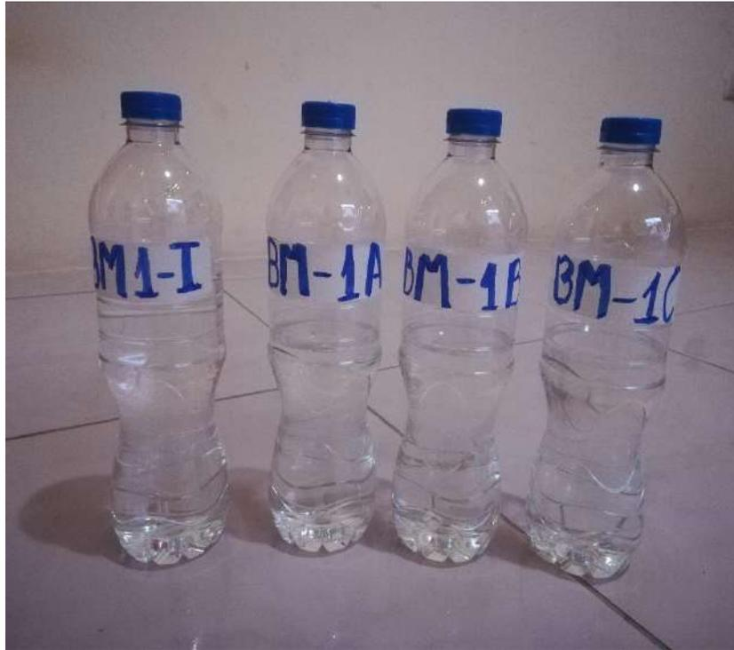
**Figura 14.** Muestra inicial bajamar recolectada a 1 milla (BM1 I) y muestras desalinizadas con replica de 3 (BM 1A, BM 1B, BM 1C)
