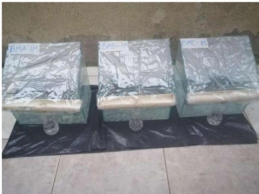
**Figura 9.** Desalinización térmica (Solar Still) de batea, agua recolectada en bajamar A, B, C, 1 milla.
