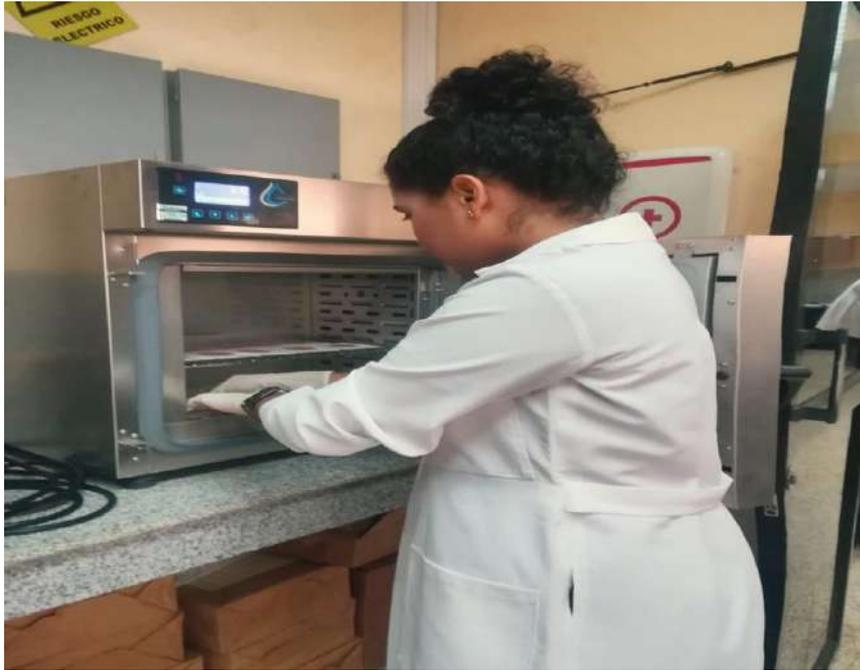
**Figura 22.** Estufa a 37° c para el periodo de incubación de coliformes totales.
