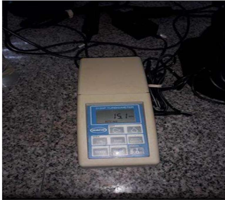
**Figura 18.** Turbidímetro para medición de turbidez.
