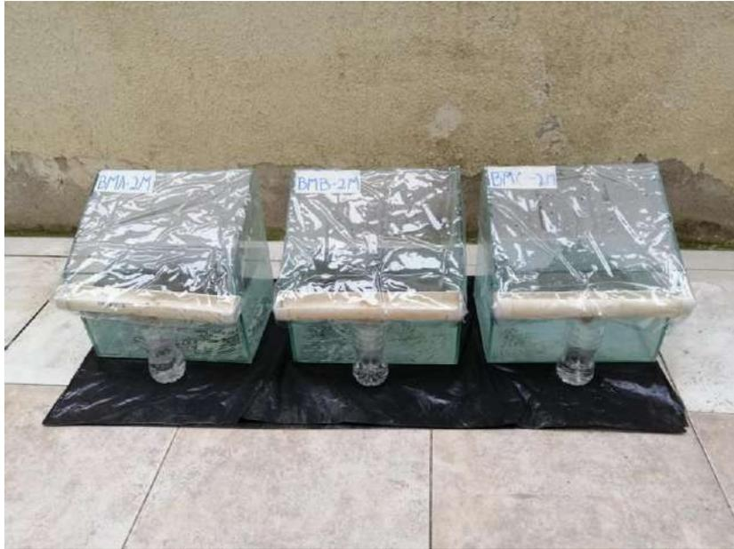
**Figura 10.** Desalinización térmica (Solar Still) de batea, agua recolectada en
