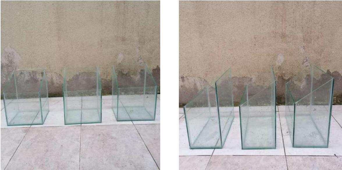
**Figura 5 y 6.** Desalinizadores térmicos (Solar Still) de batea.
