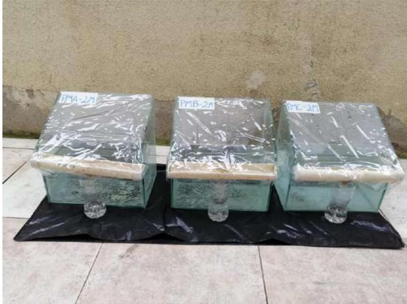
**Figura 8.** Desalinización térmica (Solar Still) de batea, agua recolectada en pleamar A, B, C, 2 millas.
