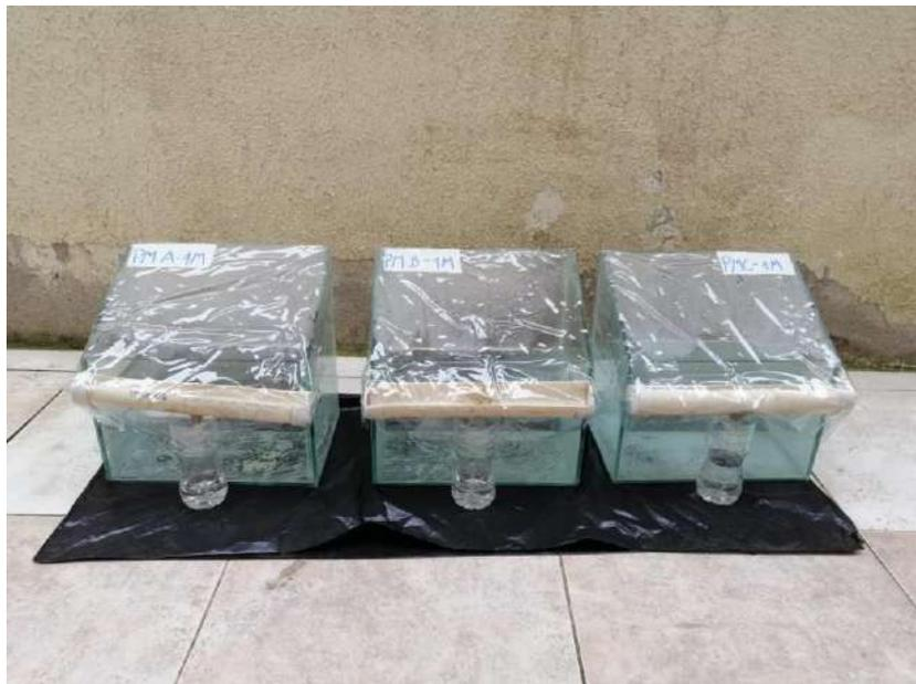
**Figura 7.** Desalinización térmica (Solar Still) de batea, agua recolectada en pleamar A, B, C, 1 milla.
