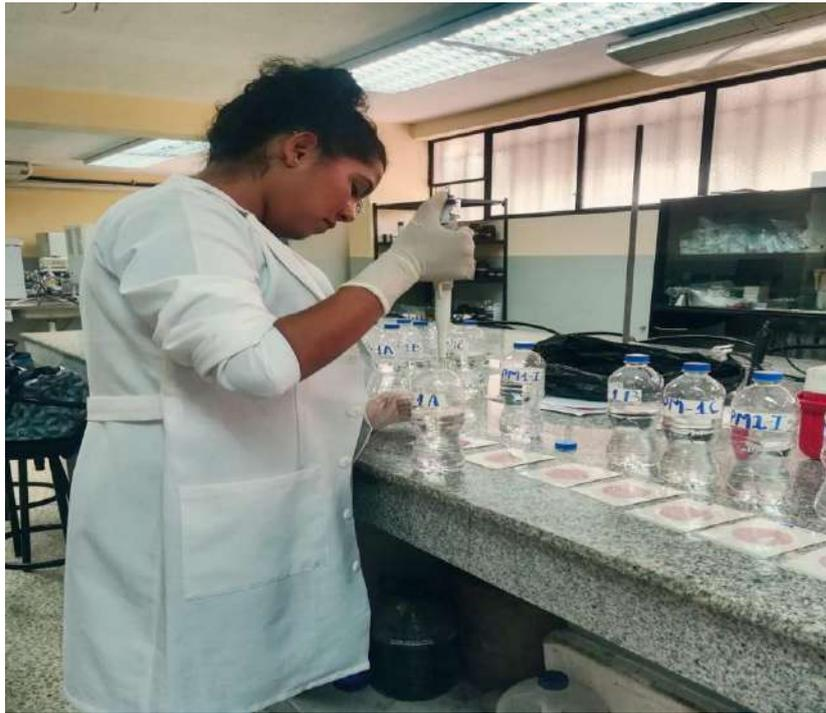
**Figura 20.** Colocamos cada una de las muestras mediante pipetas en la placa petrifilm.
