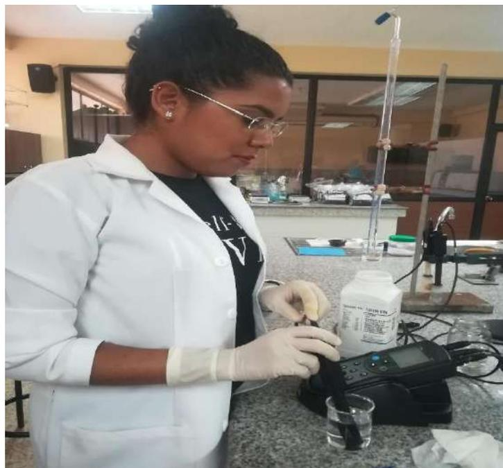
**Figura 17.** Medición de salinidad, pH y conductividad eléctrica mediante equipo multiparametro.
