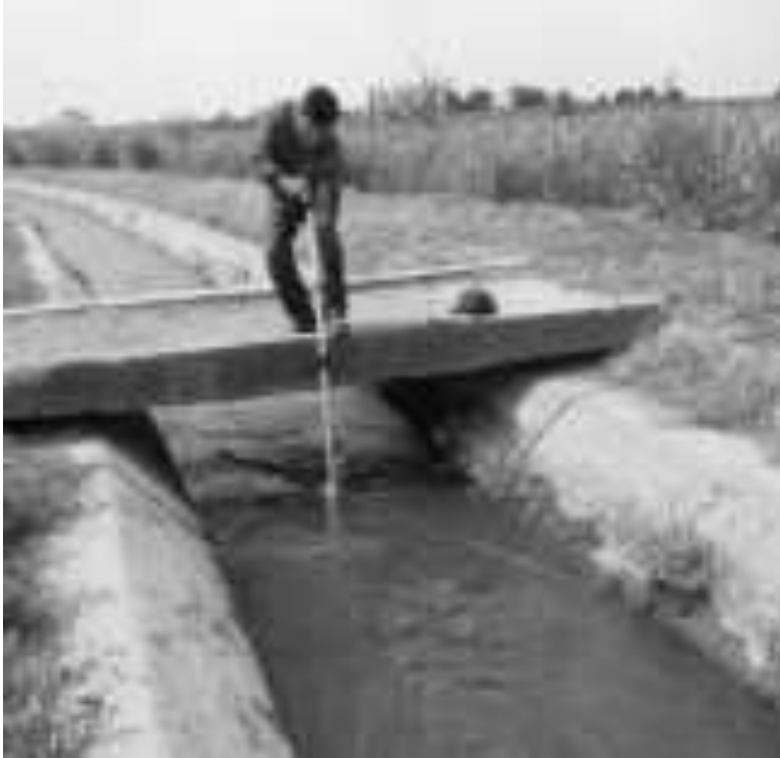
Foto N° 14. Aforo del canal de riego 1-C Fuente: El Autor, 2021.
