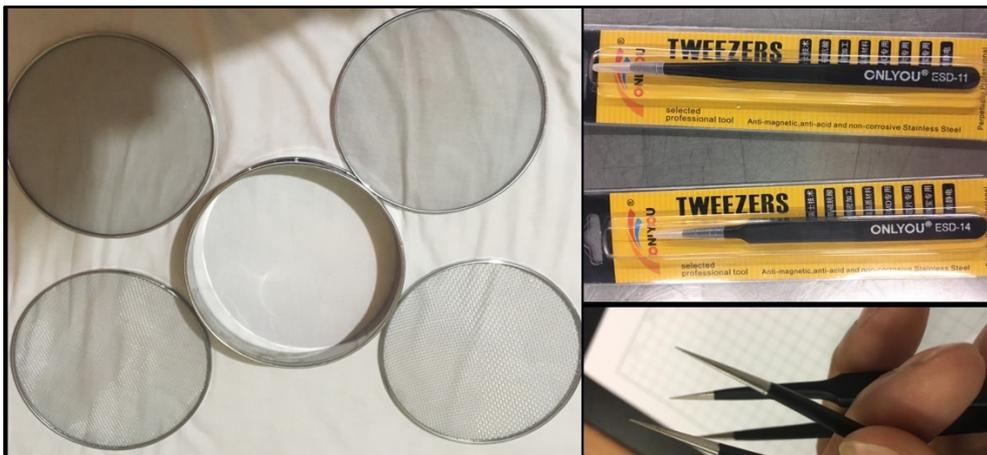
Figura 20. Materiales para cuantificación de microplásticos
