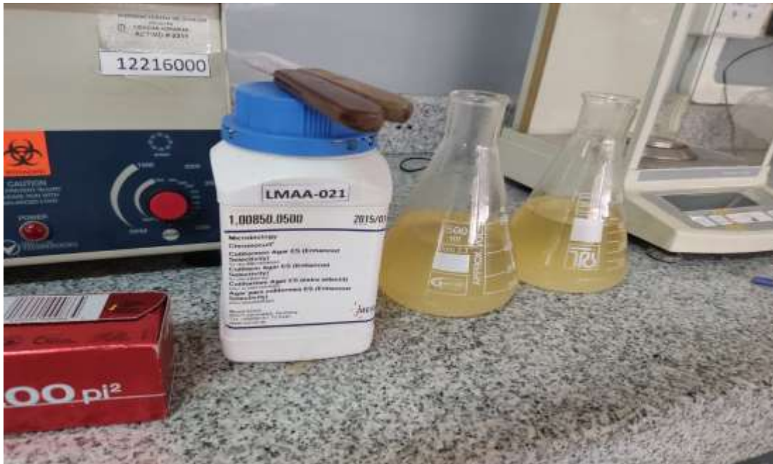
Figura 15. Preparación de agar para determinación de UFC en laboratorio de microbiología. Universidad Agraria del Ecuador sede Gye. Franco, 2022
