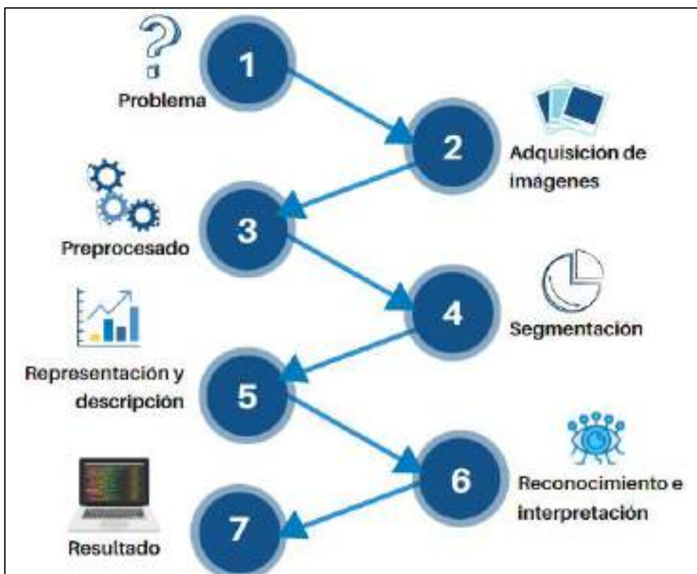
Figura 2. Etapas fundamentales del procesamiento de imágenes. Elaboración propia a partir de la fuente: Galárraga, 2018
