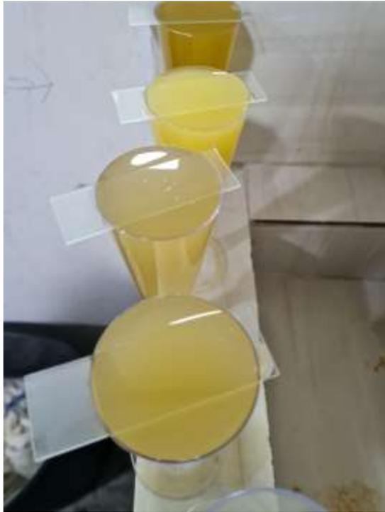
**Anexo 16. Método de flotación Wylis con cloruro de sodio densidad 1.20**
