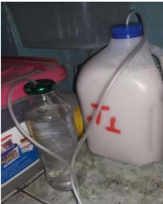
Figura 19. Fermentación alcohólica del mosto
