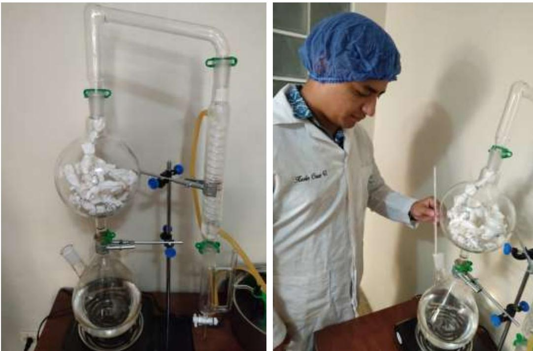
Figura 10. Proceso de hidrodestilación para la obtención de aceite esencial
