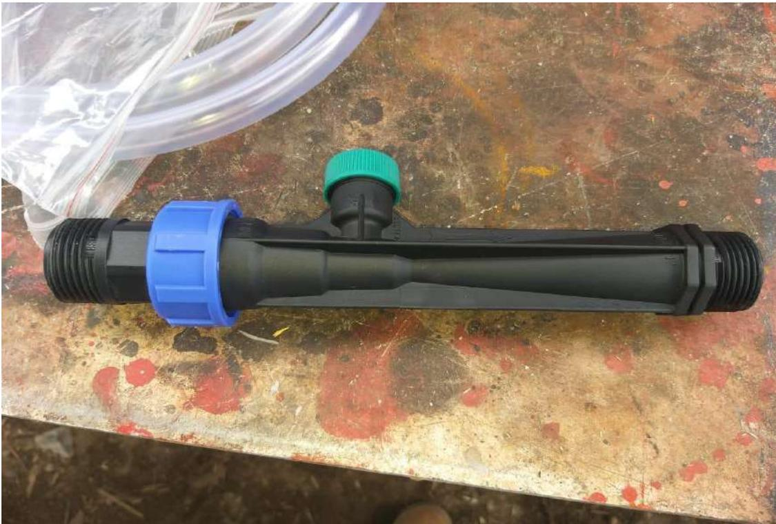
Figura 23. Inyector Venturi de 1 pulgada
