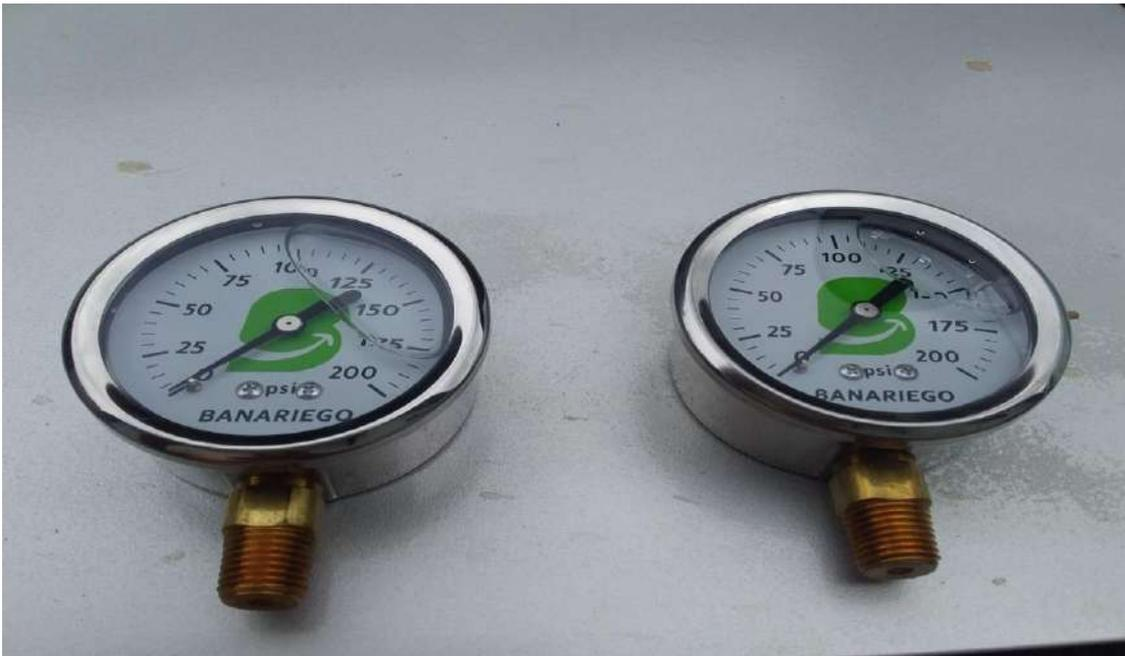
Figura 25. Manómetros para medir presión del inyector
