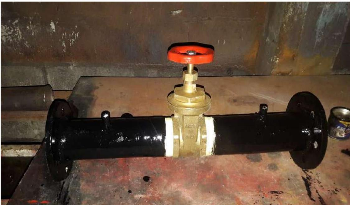
Figura 24. Colocación de bridas y llave de bronce para el inyector Venturi
