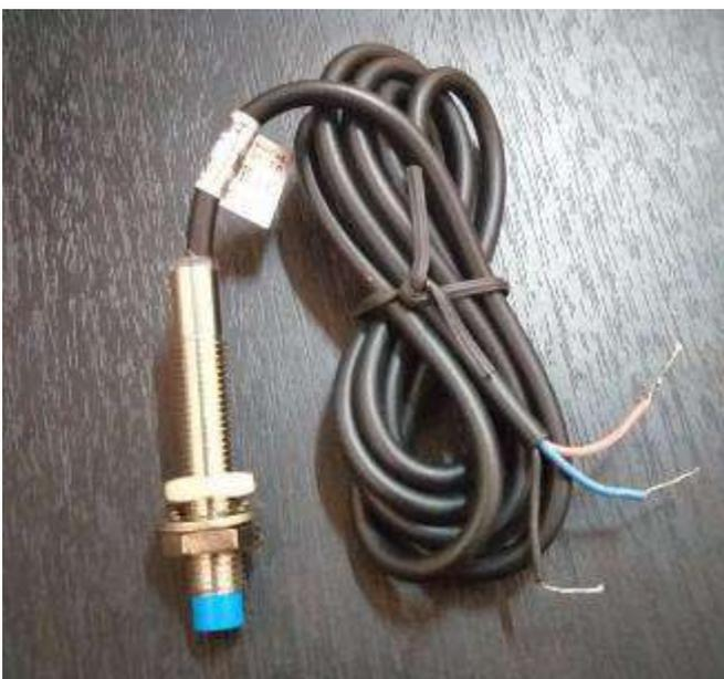
**Figura 54. Sensor Capacitivo**
