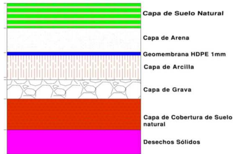
Figura 11. Detalle capa de cobertura final (Chanchay, 2014)
