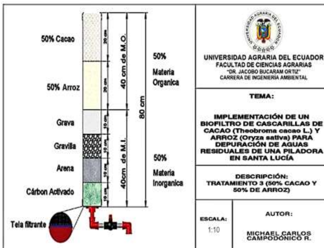
Figura 3. Ilustración del biofiltro para el Tratamiento 3. Campodónico, 2023
