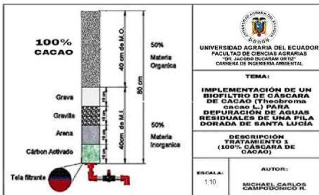
Figura 1. Ilustración del biofiltro para el Tratamiento 1. Campodónico, 2023
