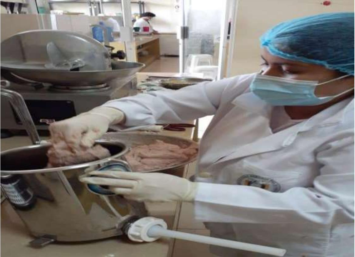
Figura 10. Colocación de la masa en la embutidora
