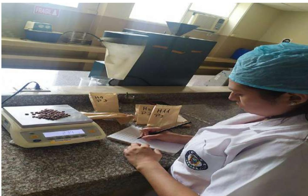
Figura 26. Peso de 100 granos con ayuda de una balanza de precisión.
