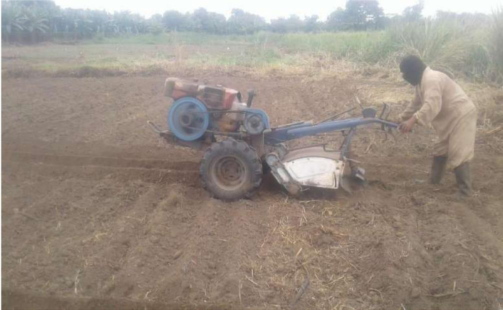
Figura 7. Preparación de terreno con surcadora
