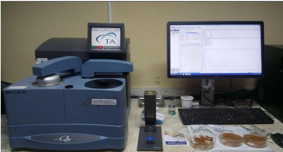
Equipo de termoanalizados METTLER Marca TA Q200
