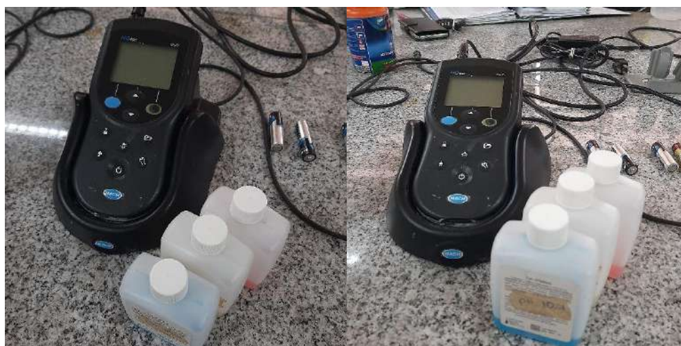
Figura 20. pH-metro y soluciones buffer para calibración Bastidas y Saguay, 2022
