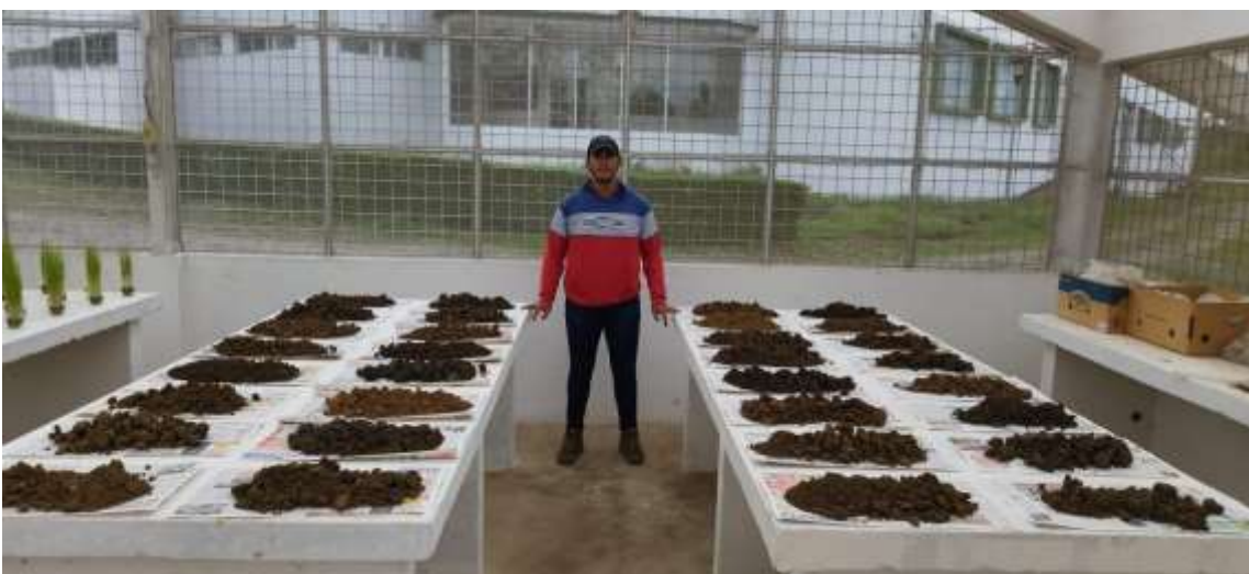
Figura 24. Muestras de suelo secándose, para después pasarlo a molerlo y realizar su respectivo análisis en laboratorio de la concentración de Cd Barcia, 2024
