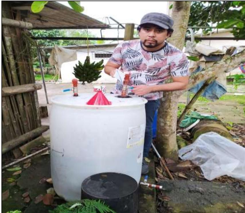
Figura 25. Biodigester terminado para la biodigestión
